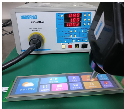
3.1 静电放电测试图 Electrostatic discharge test
